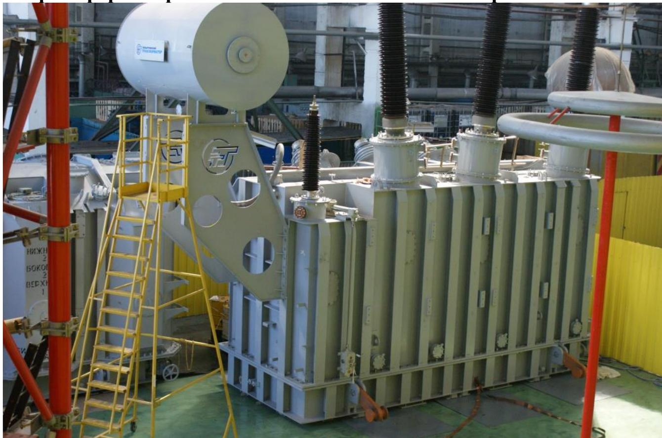
Трансформаторы стационарные силовые масляные трехфазные двухобмоточные общего назначения
